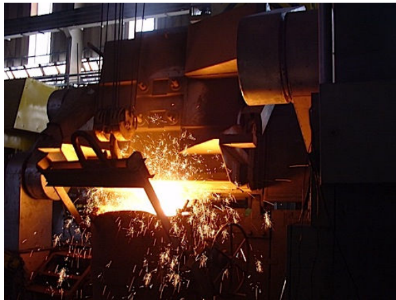
Figura 1: Processo de Fusão – Transferência do ferro do forno para uma panela. Fonte: Bernauer, 2009.
