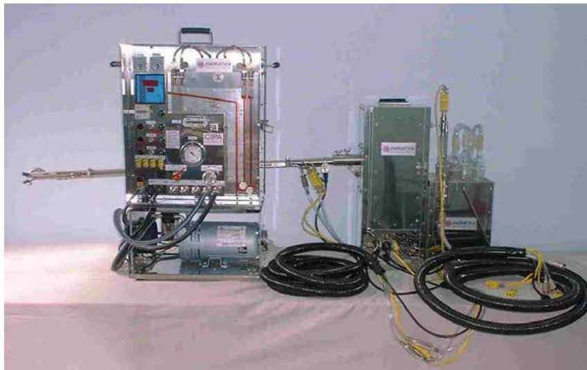
Figura 17: Equipamento CIPA - Coletor Isocinético de Poluentes Atmosféricos. Fonte: Energética Ltda.
