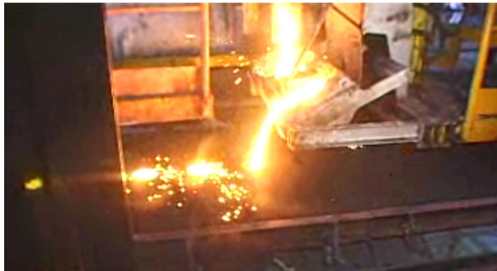
Figura 3: Processo de vazamento do ferro nos moldes. Fonte: Disa, 2009
