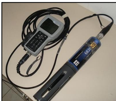
Figura 8 - Sonda multiparâmetros YSI 6820 V2 (2008).
