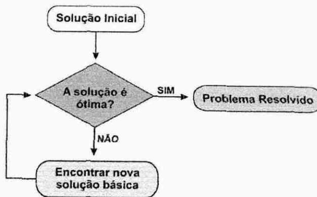
Figura 6 - Esquematização do método Simplex
