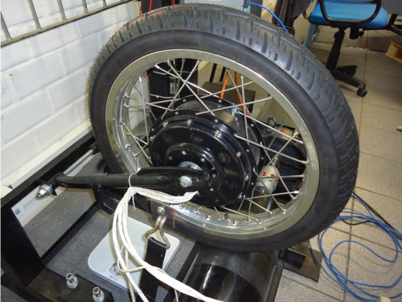
Figura 2.7 – Motor Brushless que será utilizado no protótipo
