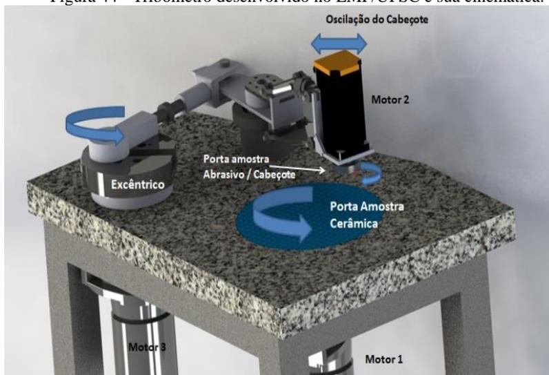
A Figura 44 mostra a bancada experimental para o brunimento plano rotativo que permite três dos quatro movimentos utilizados na indústria:
