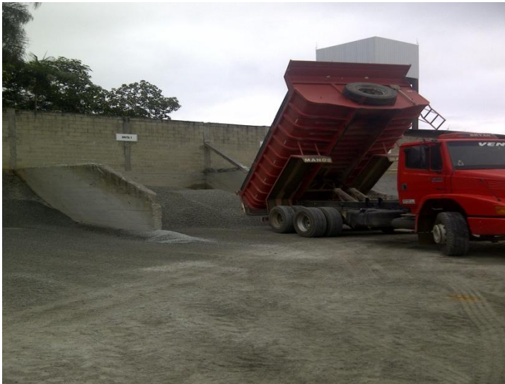
Figura 2.6 – Recebimento de insumos em uma central de concreto
