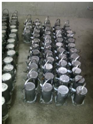
FIGURA 5.18: Moldagem dos corpos-de-prova do estudo em concreto.
