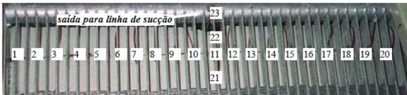
Figura 9.2 - Coletor de saída de um evaporador com 42 tubos MPE, instrumentado com 23 termopares do tipo T, para avaliar a perda de capacidade térmica devido a distribuição irregular do escoamento bifásico, Stott et al. (1999).
