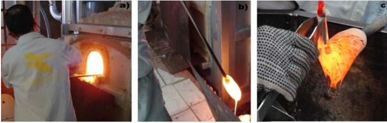
Figura 1.3 - Figura mostrando a confecção artesanal de peças de cristal. Retirada do vidro cristal fundido (a), por meio de tubos aquecidos (b), e modelamento da peça (c).
