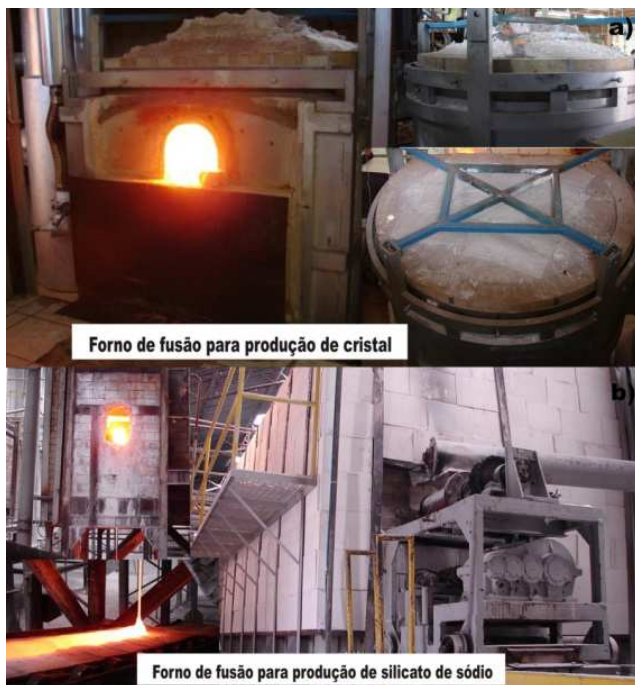
Figura 1.1 - Fotografia de um forno de fusão de vidro cristal, tipo cadinho (a), e um forno de fusão de silicato de sódio (b).
