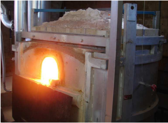
Figura 3.2 - Fotografia mostrando o forno analisado, e a respectiva janela de extração.
