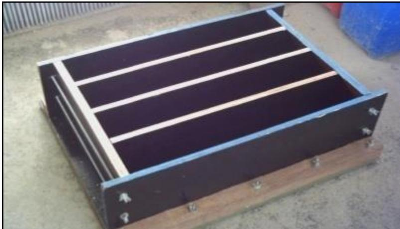
**Figura 6.11 – Fôrma de compensado plastificado para moldagem dos prismas**
