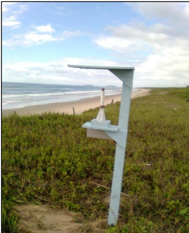
**Figura 6.8 – Aparato de vela úmida posicionado a 50m do mar**
