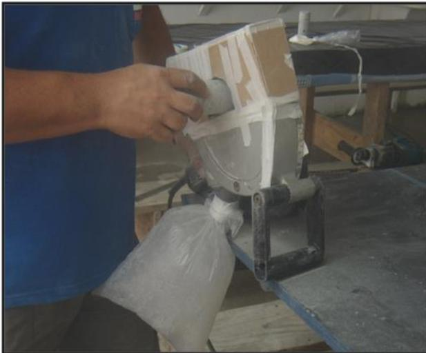
**Figura 6.15 – Adaptação da cortadora de parede para coletar o pó de concreto**
