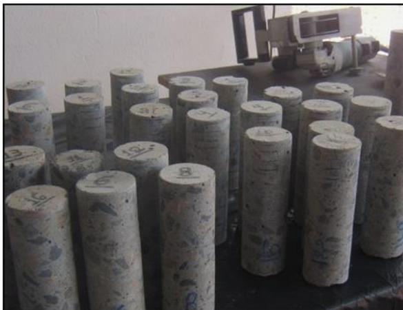
**Figura 6.14 – Testemunhos para a extração das amostras**
