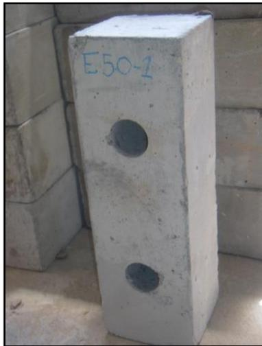
**Figura 6.13 – Posição dos testemunhos no prisma**
