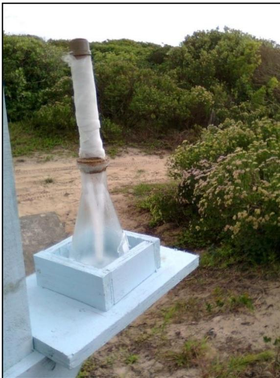
**Figura 6.9 – Aparato de vela úmida posicionado a 400m do mar**
