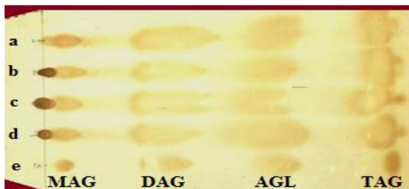
Figura 4.7 – Placa de TLC das amostras das reações de glicerólise, sem surfactante e com os Tweens 65, 80 e 85, após 48 h de reação.
