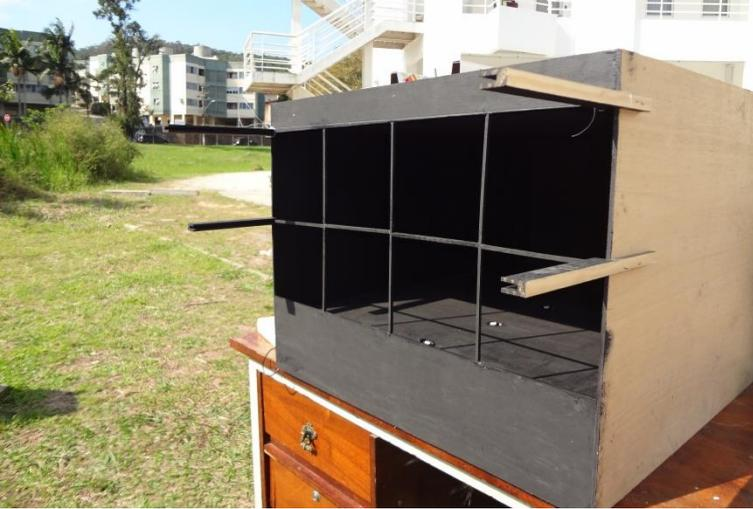
**Figura 46:** Modelo base de fachada, sem nenhum protetor solar
