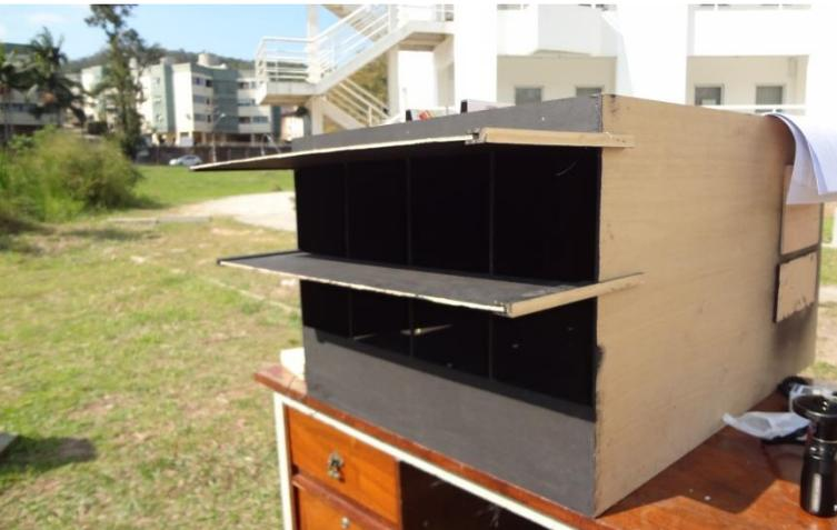
**Figura 47:** Modelo de fachada com obstrução bloqueadora na cor preta.
