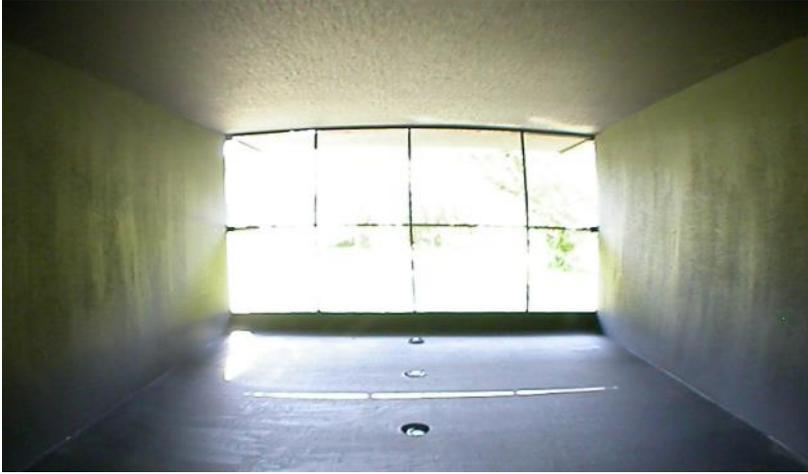
**Figura 73:** Insolação no interior da maquete com fachada com obstrução bloqueadora na cor preta, dia 02/08.
