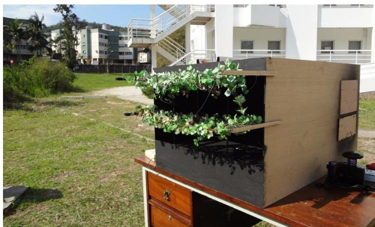
**Figura 49:** Modelo de fachada com obstrução bloqueadora vegetal.
