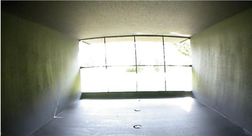
**Figura 77:** Insolação no interior da maquete com fachada com obstrução bloqueadora na cor preta, dia 03/08.
