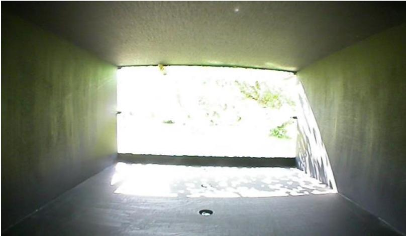
**Figura 74:** Insolação no interior da maquete com fachada com obstrução bloqueadora vegetal, dia 02/08.
