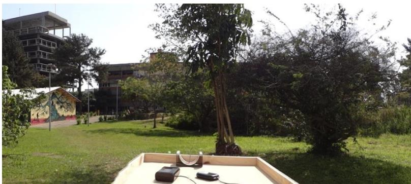
**Figura 60:** Imagem mostrando o posicionamento do luxímetro para a medição da iluminância externa.
