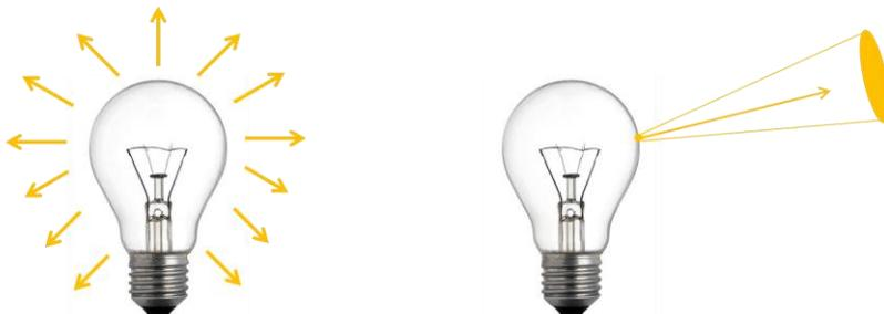
**Figura 6:** Esquema ilustrativo do fluxo luminoso e intensidade luminosa, respectivamente.
