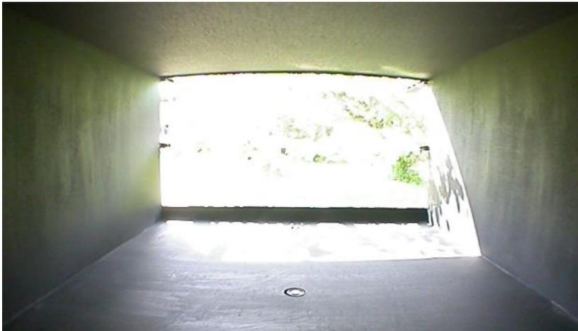
**Figura 82:** Insolação no interior da maquete com fachada com obstrução bloqueadora vegetal, dia 14/08.
