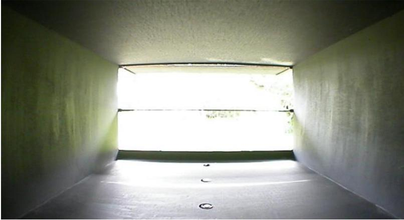
**Figura 85:** Insolação no interior da maquete com fachada com obstrução bloqueadora na cor preta, dia 15/08.
