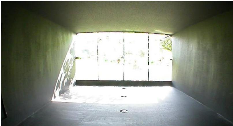
**Figura 78:** Insolação no interior da maquete com fachada com obstrução bloqueadora vegetal, dia 03/08.
