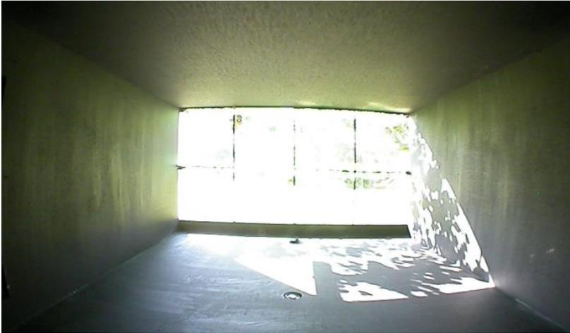
**Figura 70:** Insolação no interior da maquete com fachada com obstrução bloqueadora vegetal, dia 31/07.
