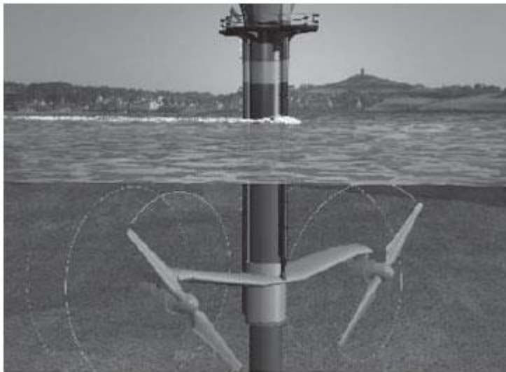
Figura 17 - Ilustração de uma Turbina utilizada para conversão da Energia Cinética das Correntes de Maré em eletricidade
