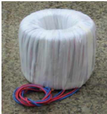
Figura 5.10 – Anel laminado bobinado, utilizado no ensaio de Core Test.
