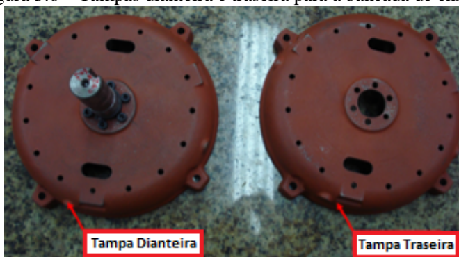
Figura 5.6 – Tampas dianteira e traseira para a bancada de ensaio.
