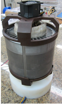
Figura 5.4 – Dispositivo eletromagnético trifásico fixado na base de ensaio.
