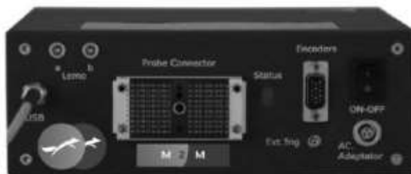
Figura 2.5 - Foto do aparelho ultrassom 'MultiX Pocket', da empresa M2M NDT
