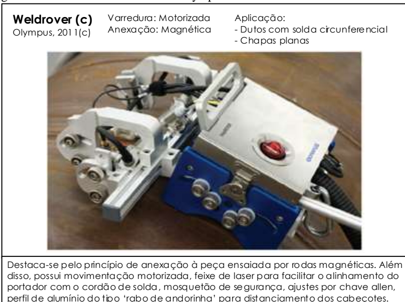
Figura 2.10 - Portador Weldrover da Olympus
