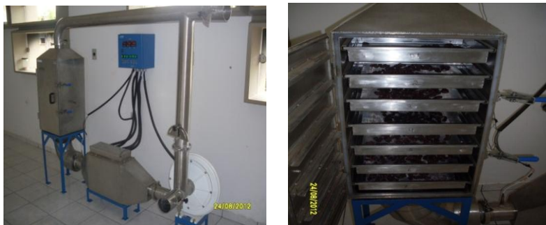
Figura 7: Secador convectivo utilizado no estudo para secagem de uva Crimson.
