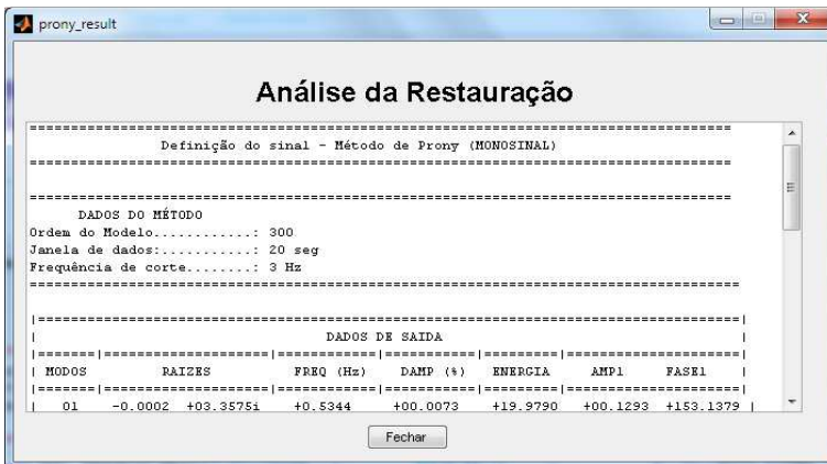
Figura 3.23 – Análise da oscilação eletromecânica pelo método de Prony.
