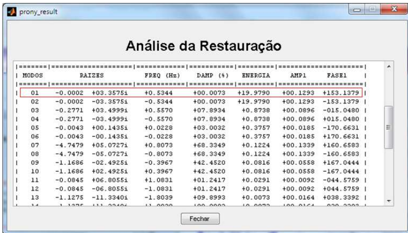
Figura 4.36 – Análise da oscilação durante a restauração do sistema.
