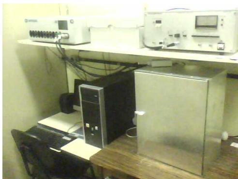
Figura 43: Potenciostato e caixa metálica onde se encontra a célula eletroquímica.
