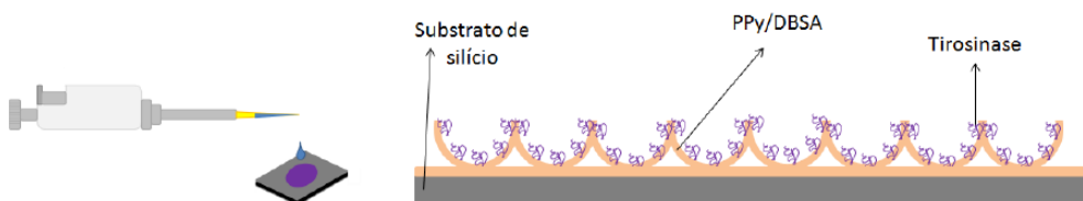
Figura 49: Método de imobilização da enzima e plataforma polimérica nanoestruturada de PPy com tirosinase.
