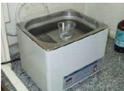
Figura 38: “Banho-maria” com o béquer contendo a solução de hidrofiliização e os substratos.
