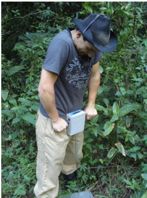
Figura 12: Utilização do PenetroLOG em uma área de mata nativa na bacia hidrográfica do Vacacaí-Mirim, 2011.
