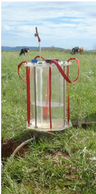
Figura 11: Método Cornell Sprinkle Infiltrometer em uma área de pastagem na bacia hidrográfica do Vacacaí-Mirim
