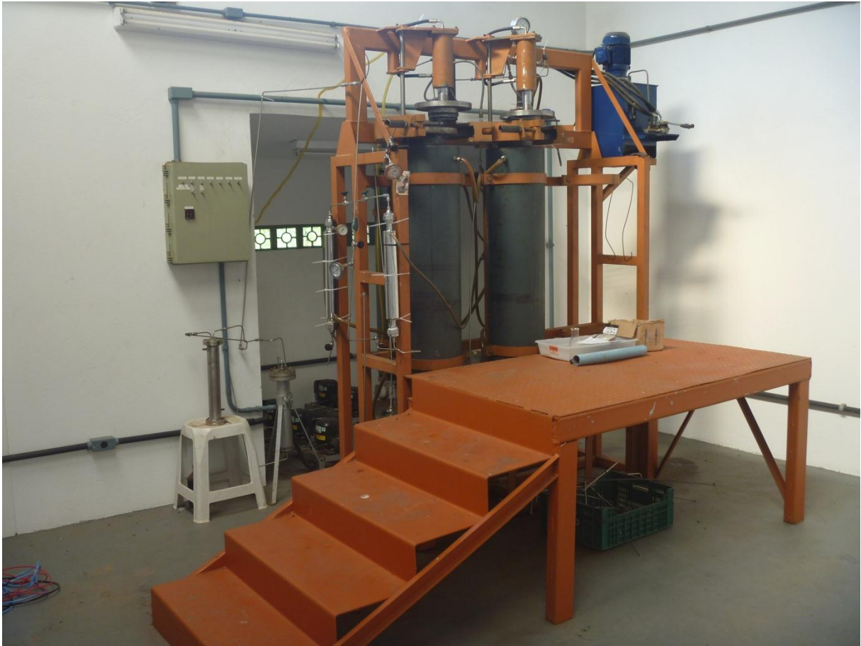
Figura 16: Extrator pelo método de fluido supercrítico (Autor, 2012).
