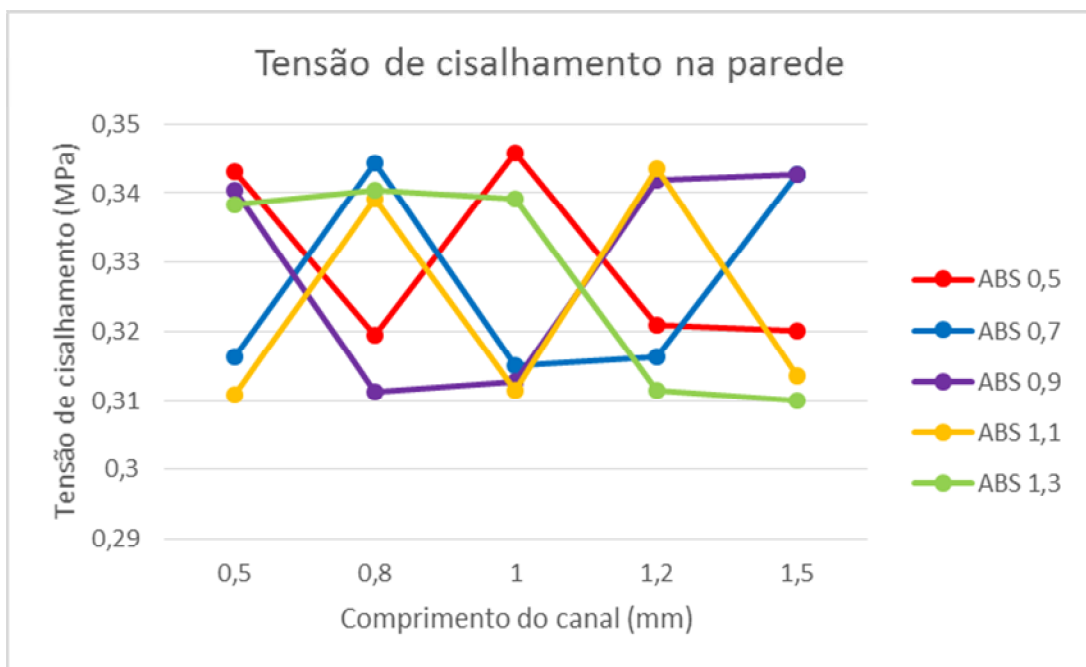
Figura 72 - Taxa máxima de cisalhamento caixa com uma cavidade em ABS e espessura de 2mm. Fonte: Autor.
