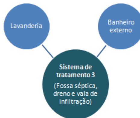
Figura 14: Rede sanitária do sistema de tratamento de efluentes 3.
