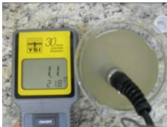
Figura 16: Medição da salinidade com salinômetro YSI.
