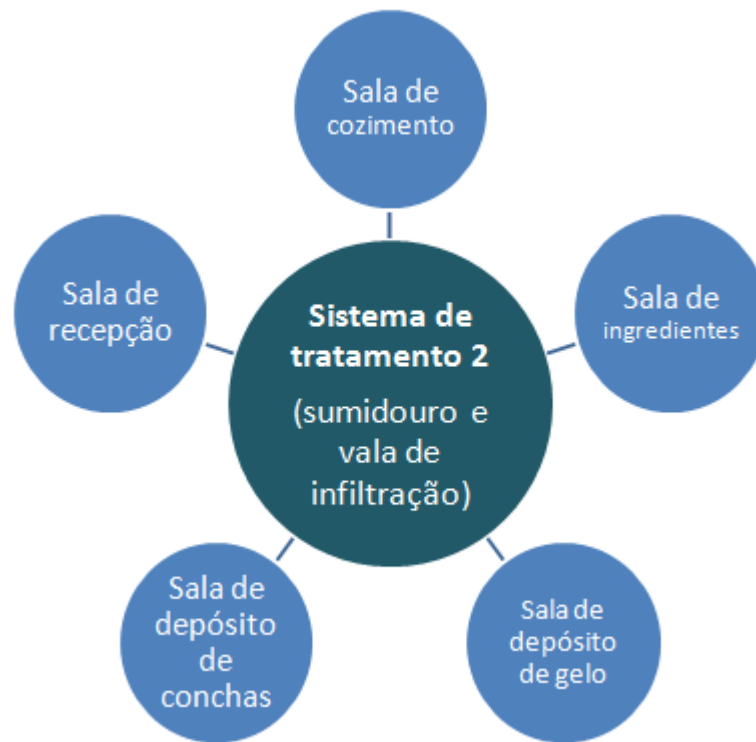
Figura 13: Rede sanitária do sistema de tratamento de efluentes 2.
