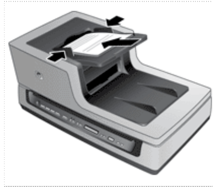
Figura 3: Escaner – entrada do Alimentador Automático de Folhas (ADF) Fonte: Centro de suporte empresarial, 2007 http://h20000.www2.hp.com/bizsupport/TechSupport/Home.jsp
