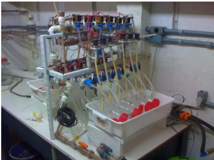
Figura 04: Sistema de respirometria.
