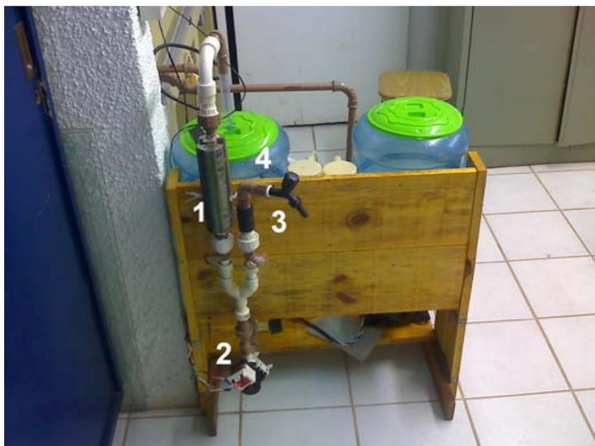
Figura 10: Sistema de magnetização da água. 1) Par de condicionador hidromagnético. 2) Eletro-bomba de 34w – 1200l/h – 1MCA. 3) Registro para coleta da água. 4) Reservatório com capacidade de 20 litros.
