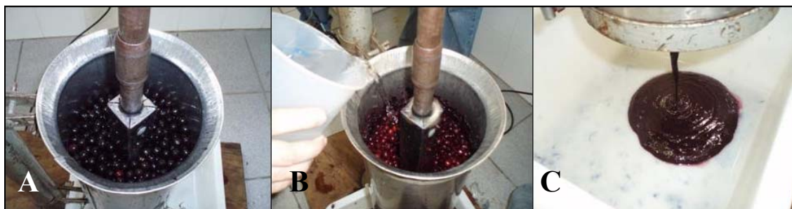
Figura 1: produção de açaí em despolpadeira vertical; frutos dentro do cilindro de aço inoxidável (A); adição de água durante o despolpamento (B); saída do açaí por orifício no fundo da despolpadeira (C).
