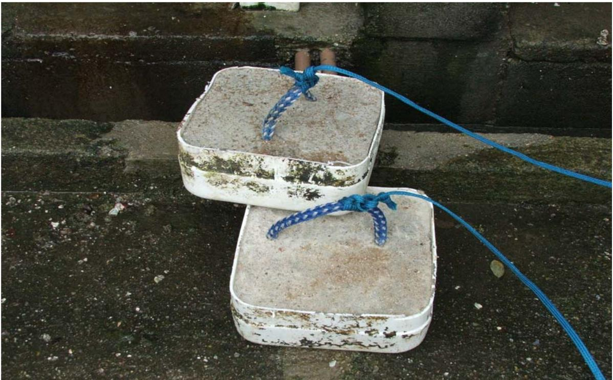
Figura 27: Poitas utilizadas para ancorar os cabos principais ao fundo do mar.
