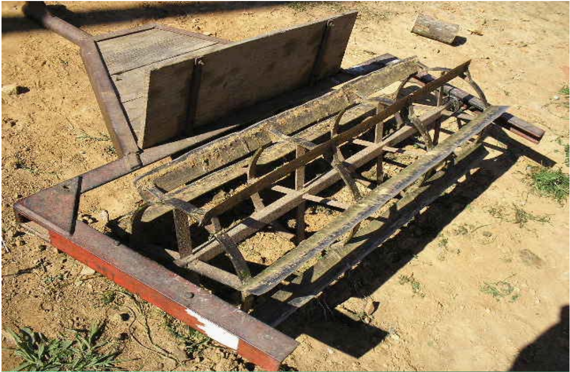
Figura 01: Rolo Faca utilizado para acamamento das culturas de cobertura.
