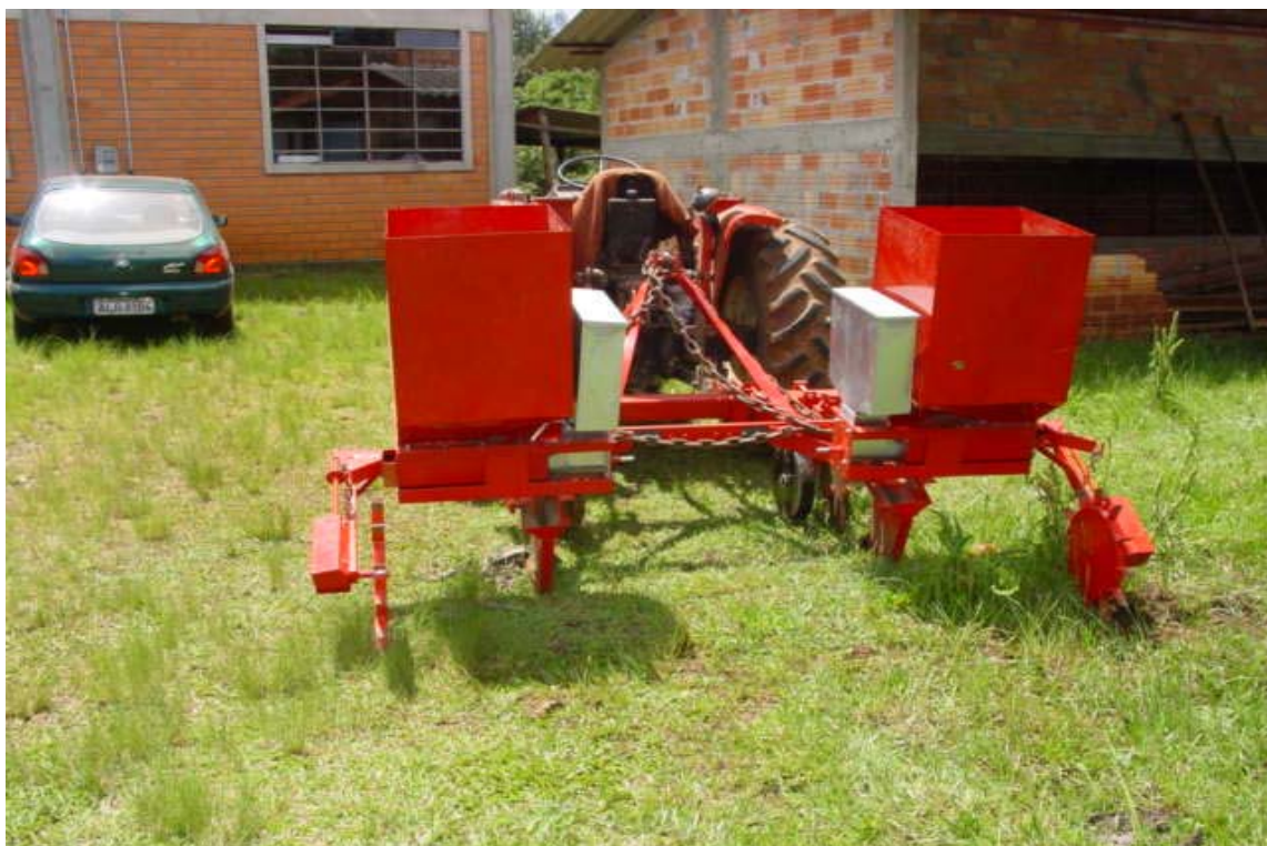
Figura 08: Máquina para plantio direto de hortaliças nas culturas da melancia, abóbora, pimentão, repolho, entre outras.
