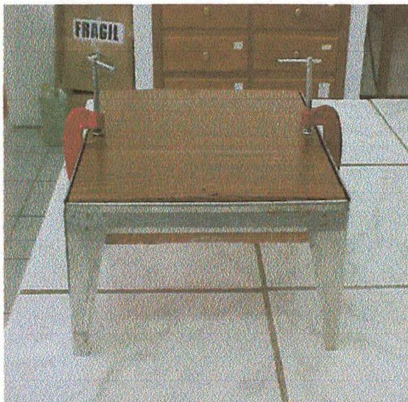
FIGURA 8. Prensa fechada compactando os materiais utilizados na massa do tablete.
