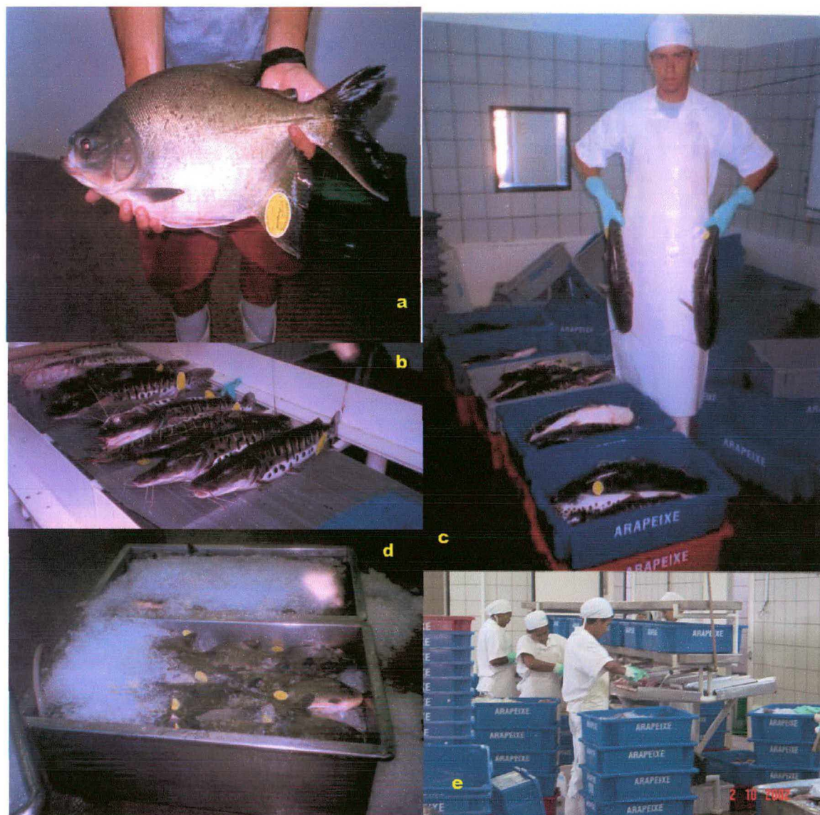
Figura 16: Foto a: peixe (tambaqui) devidamente etiquetado; Foto b: peixes entrando para dentro do frigorífico pela esteira, passando pela ducha de água clorada. Observe as etiquetas; Foto c: peixes sendo recepcionados dentro do frigorífico e sendo acondicionados nos monoblocos; Foto d: caixa de inox utilizada na recepção dos peixes. Nota-se que o peixe já foi devidamente gelado; Foto e: interior do frigorífico com as funcionárias na mesa de filetagem.
