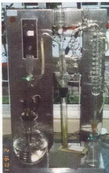
**Figura 9:** Aparelho de destilação Kjeldahl, usado para determinação do nitrogênio total e nitrogênio amoniacal de sucos, mostos, vinhos e outros.
