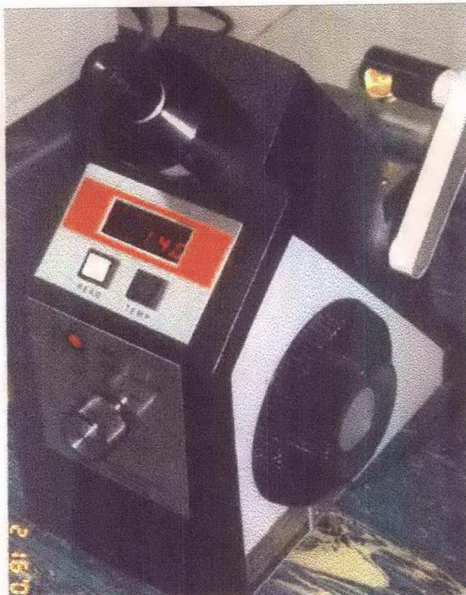
**Figura 12:** Peagâmetro, modelo Americam optical, Abbe refractometer, com escala de no mínimo 0,1 unidade de pH. Usado para aferir o pH de sucos, mostos, vinhos e outros líquidos.
