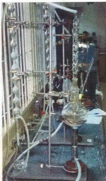
**Figura 4:** Aparelho Cazenave-Ferre equipado com uma coluna de refrigeração de 40 cm, é usado para determinar a acidez volátil dos mostos e vinhos.
