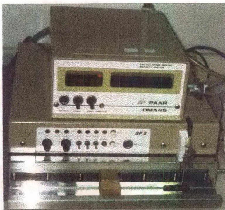
**Figura 5:** Densímetro Antor Paar DMA 45, fornece a densidade do mosto e do vinho.
