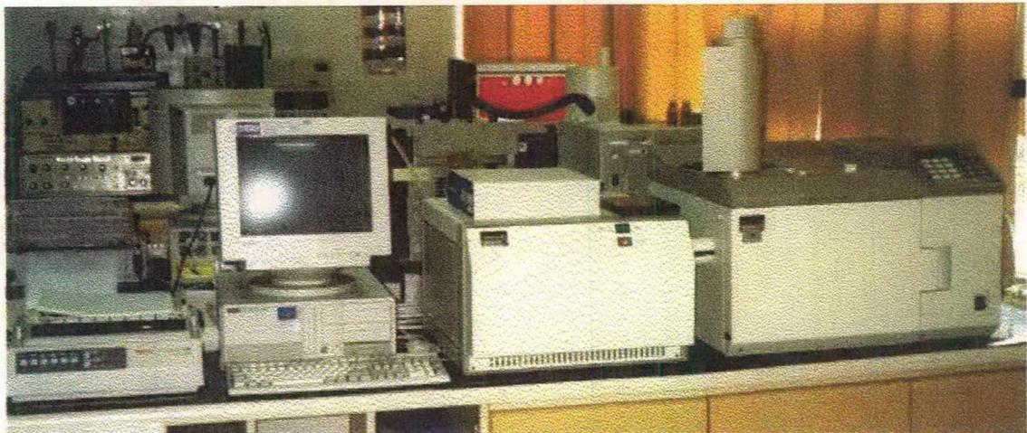
**Figura 7:** Cromatógrafo a gás marca Perkin-Elmer, modelo Autosystem XL, equipado com detector seletivo de massa (Q-MASS 910), utilizado para detectar compostos voláteis presentes no vinho em pequenas quantidades.
