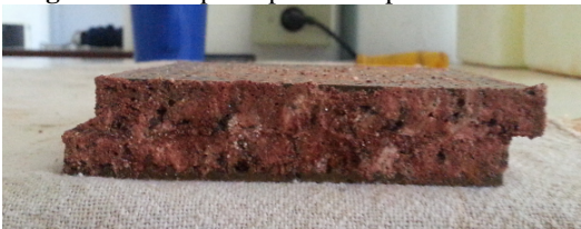
Figura 34. Corpo de prova rompido – Ponto 02.
