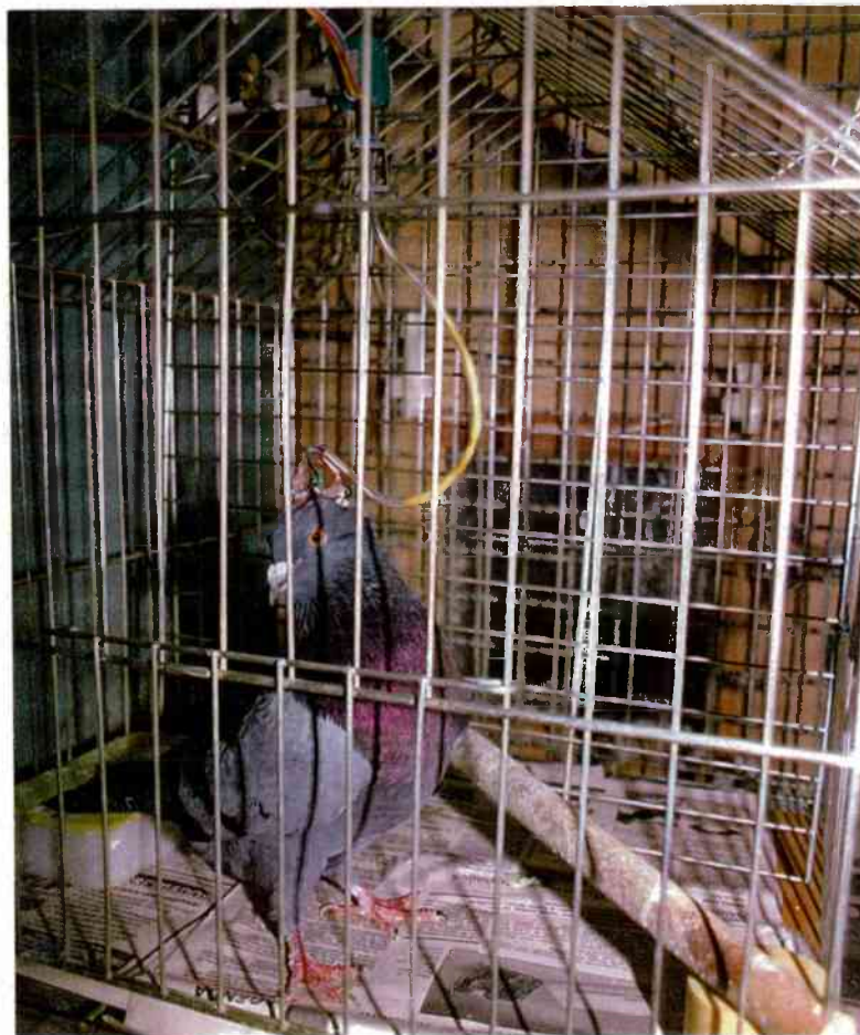
Figura - 3 - Gaiola de registro com isolamento farádico, evidenciando os fios conectados aos “plugs” na cabeça do pombo e ao “swivel” giratório. Ao fundo e à direita do pombo, aparece o vidro unidirecional para visualização do pombo dentro da sala com isolamento acústico.
