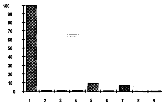
Fig. 39 - Análise Harmônica - Célula A Tensão Nominal (THD = 11,91%)
