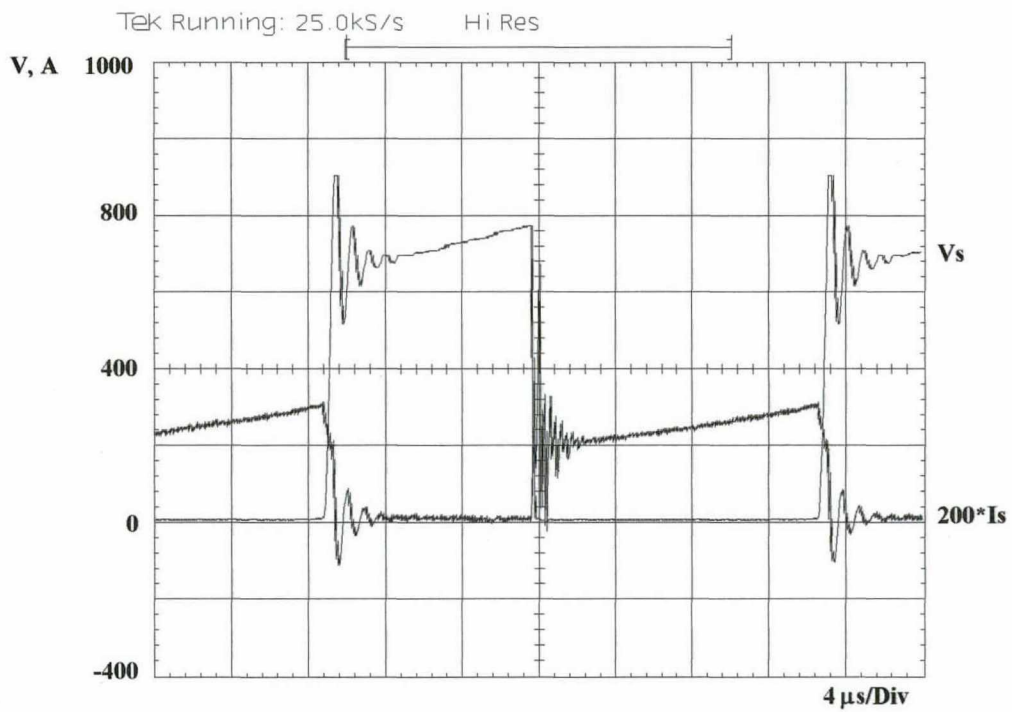
Fig. 4.10 - Tensão e Corrente no Interruptor S
