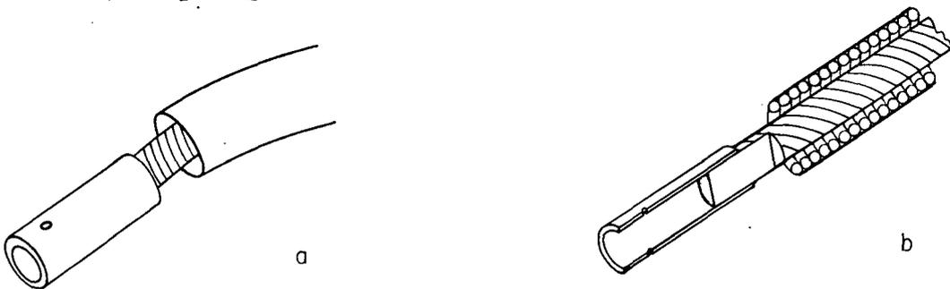
FIGURA 5.14 - Luva de acoplamento, veio flexível e capa flexível:
