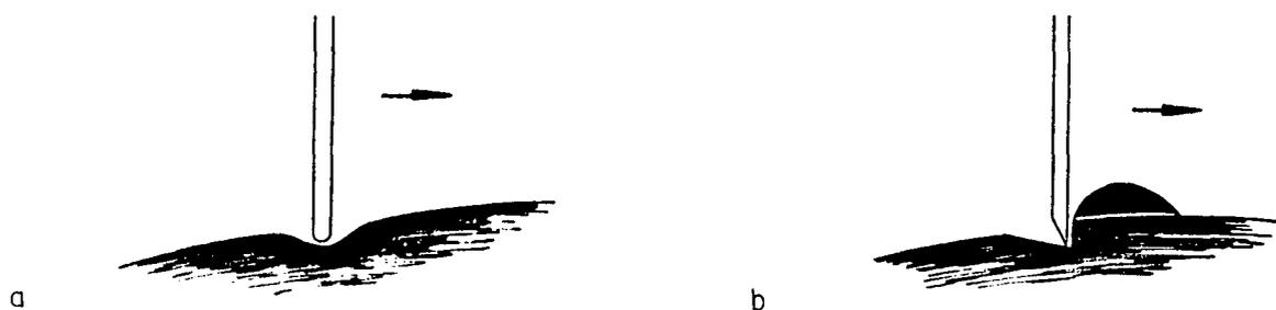
FIGURA 3.2 - Lâminas em contato com o couro: a) lâmina sem fio; b) lâmina afiada.
