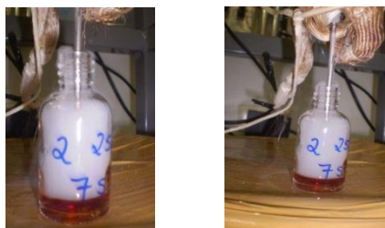
Figura 17 - Extrato obtido a 250 bar/50 °C com CO 2 + 75 % etanol.
