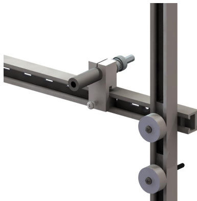
Figura 3.1: Projeto do array desenvolvido em software com geometria espiral, barras de sustentação com maior rigidez e maior precisão nas peças de encaixe dos microfones.
