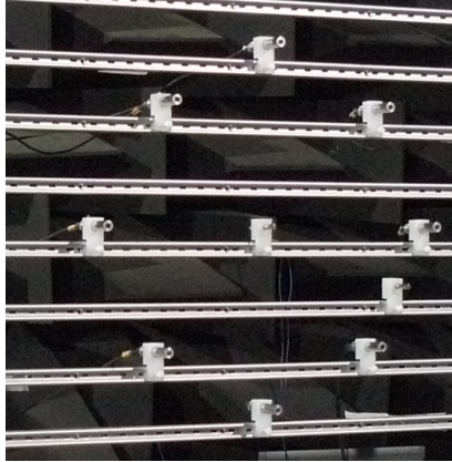
Figura 4.3: Erros de posicionamento dos microfones, perturbação gerada aleatoriamente por software . Geometria 1 - Erros de até 1,0 cm.
