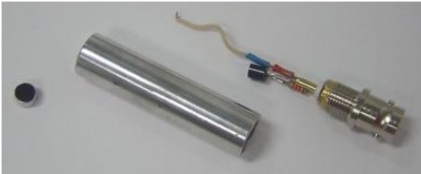
Figura 3.11: Detalhe dos microfones utilizados. Cápsula de eletreto, corpo de alumínio de 1/2 polegada e circuito pré-amplificador (da esquerda para a direita).
