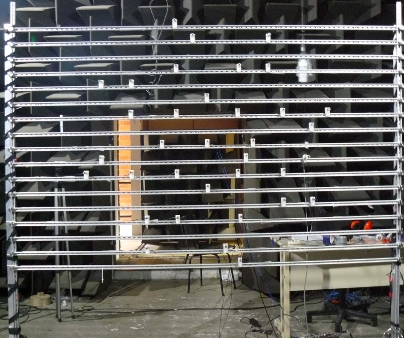
Figura 3.2: Foto do array construído, com a nova geometria projetada, disposto no interior da câmara semianecoica do LVA, local onde ocorreram as medições de erros de posicionamento dos microfones. É possível observar a geometria projetada.
