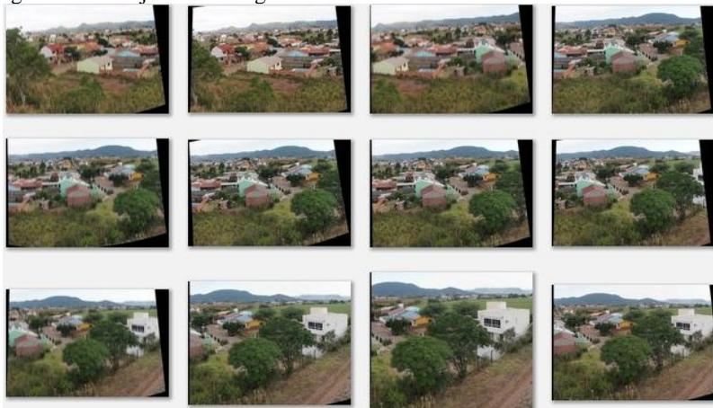
Estas foram escolhidas por ser uma situação comum em recobrimentos de grandes áreas por *drones*. Utilizou-se o *software* Hugin por ser um aplicativo livre e apresentar bons resultados. A Figura 44 apresenta uma montagem de imagens coletadas pelo *drone* e processadas para a mosaicagem.
