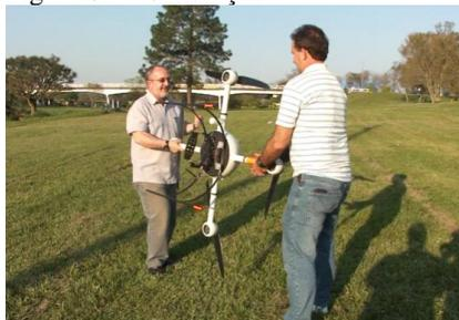
Após 84 testes de decolagens e pousos e o levantamento de uma série de imagens no modo assistido optou-se por calibrar novamente o magnetômetro, pois este se apresentava com um percentual baixo de ganho. O magnetômetro foi calibrado, porém o sistema não reconheceu o GPS e não mais possibilitou a partida dos motores. O fabricante sugere que o equipamento retorna a fábrica para uma inspeção geral.
