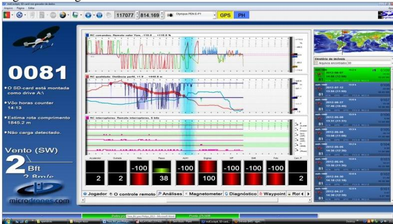
Figura 73 - Relatório automático para análise de parâmetros importantes e leituras dos sensores
