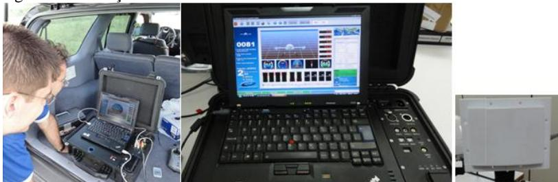
A estação base combina múltiplas funções, sendo que a mais importante delas é como estação receptora de vídeo e de dados de telemetria enviados pelo *drone*. Os sinais recebidos são decodificados e preparados para o uso em qualquer computador ou plataforma de trabalho, além disso, a estação base serve como unidade de carga de baterias recarregáveis.
