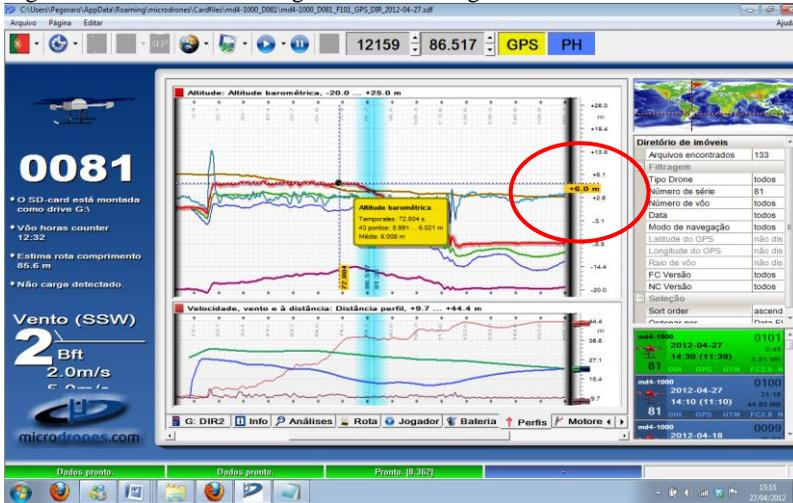
A Figura 70 representa a área de pouso, que fica em um nível inferior ao da decolagem. O registro de altura barométrica é negativo (-8,7 m), isto é, tem-se uma altura negativa em relação à decolagem.
