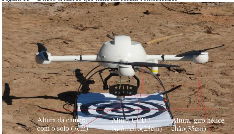
Com relação ao sistema de coordenadas do dispositivo, referencial inercial, os ângulos de rotação são definidos como: ângulo de guinada ( $\Psi$ ) em torno do eixo Z, ângulo de arfagem ( $\Phi$ ) em torno do eixo Y e o ângulo de rolamento ( $\Theta$ ) em torno do eixo X. O sistema de coordenadas da câmera depende da sua orientação quando acoplada sobre o VANT.
