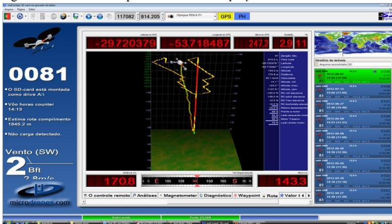
A Figura 72 apresenta os registros da rota quanto aos comandos do RC, qualidade do sinal e interrupções do RC. Na Figura 73 pode-se verificar o relatório gerado automaticamente para análise de parâmetros importantes e leituras dos sensores. Na Figura 74 os dados relativos a telemetria.
