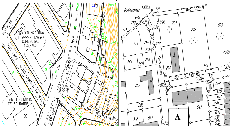
Figura 13: (A) carta topográfica com a representação das feições dos objetos e (B) carta cadastral, na qual se pode notar o identificador único para cada parcela, os pontos limites legais demarcados fisicamente e os pontos da rede de referência. (Fontes: IPUF, 2009 e LIEBBRAND, 1984, respectivamente).
