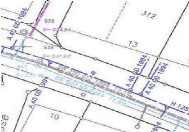
Figura 14: extrato de carta temática com a representação gráfica dos temas de infraestrutura urbana subterrânea, disposta sobre uma base cartográfica cadastral do sistema básico do CTM. (Fonte: SWISSTOPO, 2012).
