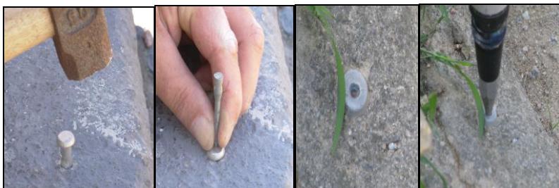
Figura 40: demarcação e utilização de ponto de referência materializado com pino de metal.
