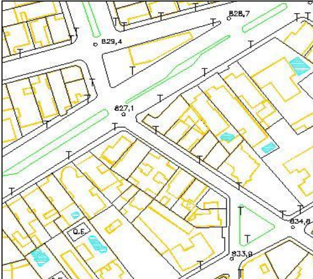
Figura 28: fragmento de carta em escala cadastral, de origem fotogramétrica, com a representação das feições físicas do terreno (contornos dos objetos) identificada nas fotografias aéreas no momento da restituição fotogramétrica. (Fonte: Fernandes, 2009.).
