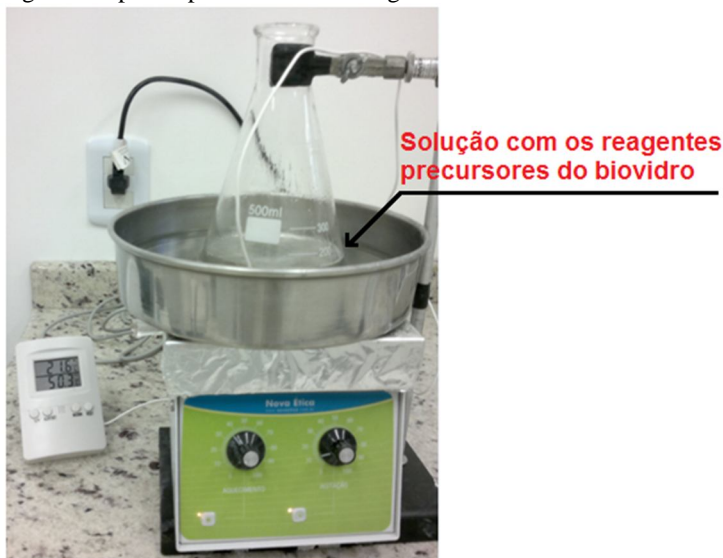
Figura 9: Aparato para síntese via sol-gel do biovidro 58S.
