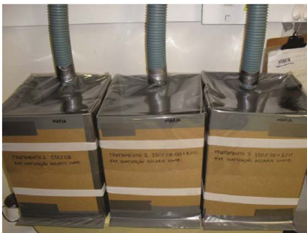
Figura 60. Experimento com os três compartimentos pilotos para o tratamento de fezes humanas – etapa 2.
