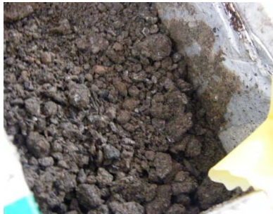
Figura 38. Material produzido no experimento de secagem das fezes humanas.
