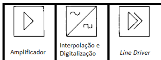
Figura 3.8 – Condicionamento de sinal do ROD 800
