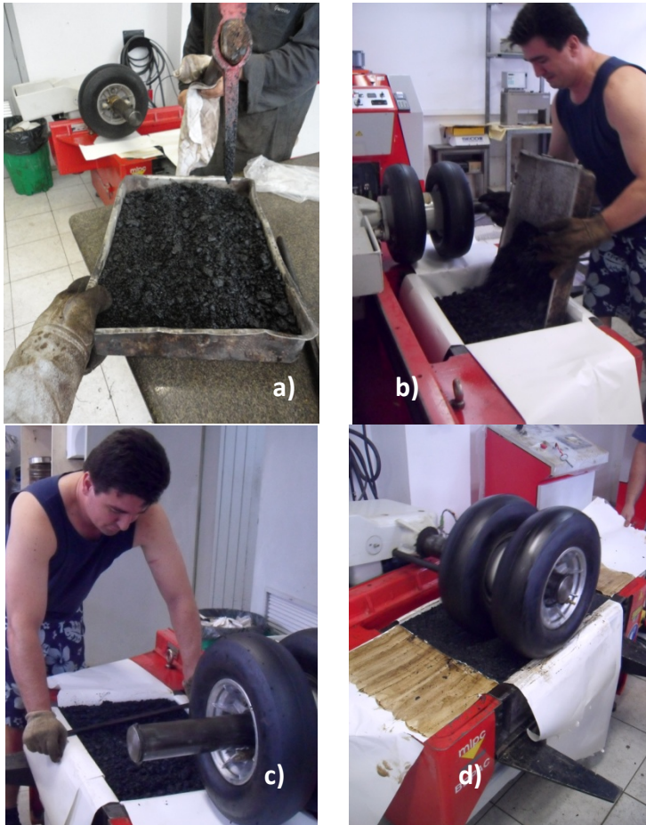
Figura 6.23 – Processo de compactação para as placas de módulo complexo e fadiga. Preparação da mistura (a), Colocação da mistura na compactadora (b), Nivelamento da mistura no molde (c), e processo de compactação (d)
