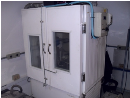
Figura 6.14 – Câmera de condicionamento térmico utilizada para o ensaio de Duriez.
