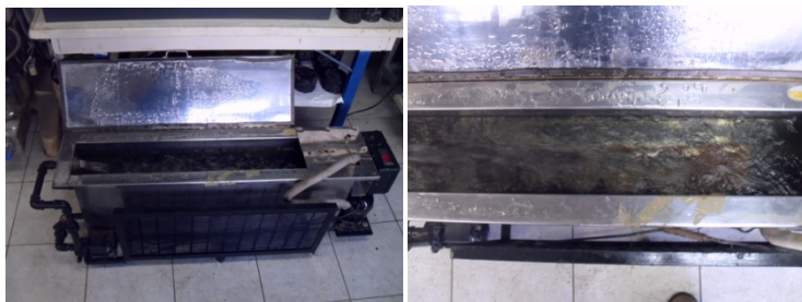
Figura 6.15 – Condicionamento na água a 18°C
