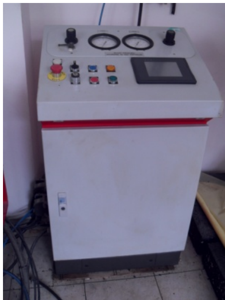
Figura 6.21 – Cabine de comando da máquina de compactação de placas.
