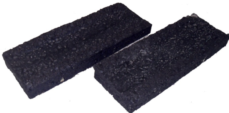
Figura 7.3 – Par de placas compactadas para o ensaio de deformação permanente.
