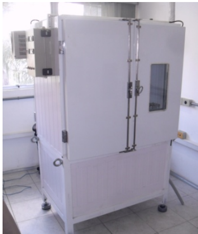
Figura 5.14 – Segunda geração da máquina de módulo complexo e fadiga (FADECOM) da UFSC
