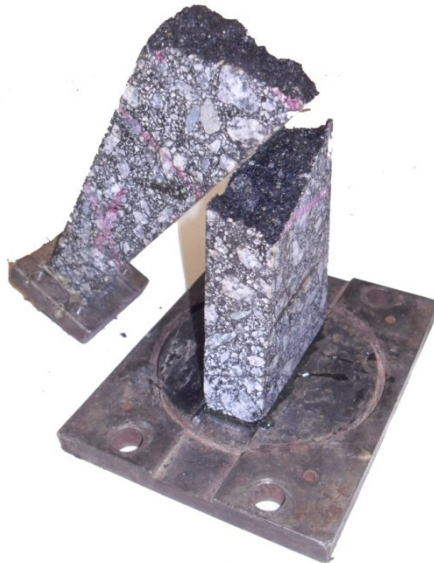
Figura 6.29 – Corpo de Prova com falha no terço médio
