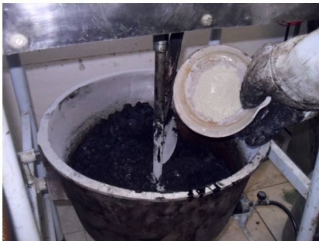
Figura 6.10 – Adição das ZEÓLITAS durante o processo de misturado
