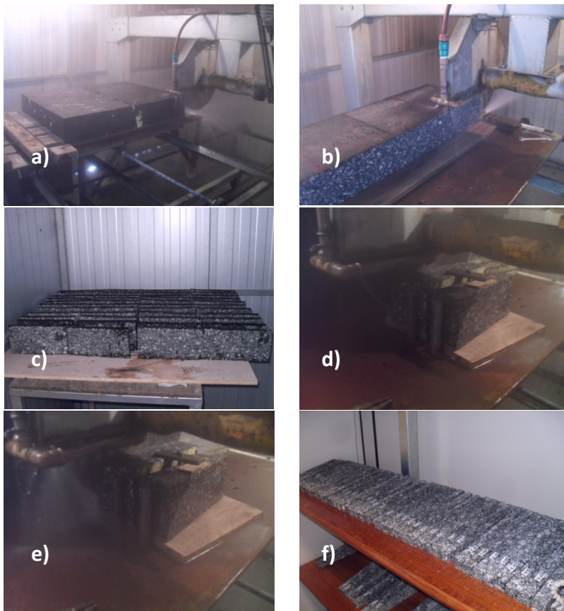
Figura 6.25 – Processo de corte das placas. Primeiro corte (a), segundo corte (b) pranchas resultantes (c), primeiro corte dos trapézios (d) corte final dos trapézios (e), corpos de prova trapezoidais resultantes (f).
