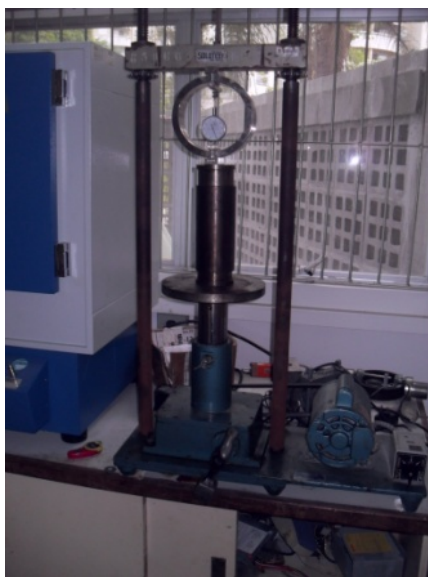
Figura 6.11 – Prensa Marshall em processo de compactação dos CPs. Duriez
