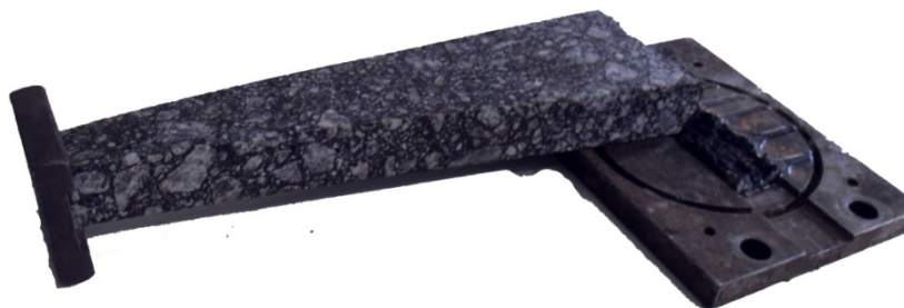
Figura 6.27 – Corpo de Prova rejeitado
