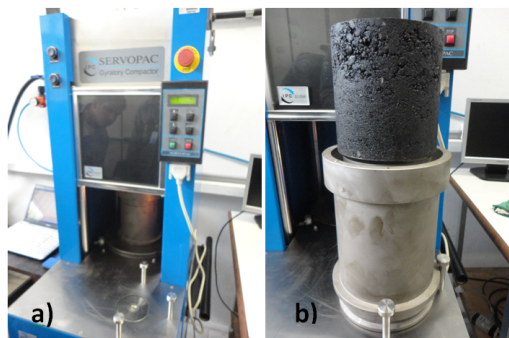
Figura 6.17 – Ensaio da PCG. Conjunto CP e moldes dentro da máquina (a) e Corpo de Prova final (b)
