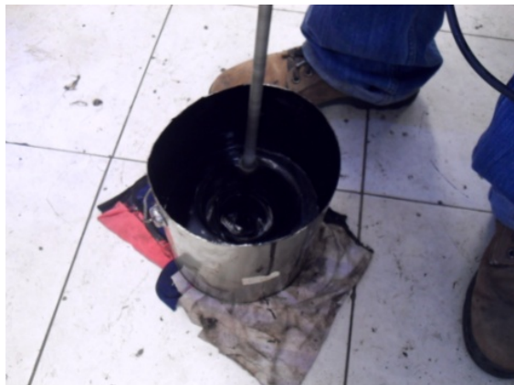
Figura 6.6 – Homogeneização do ligante asfáltico após a modificação.
