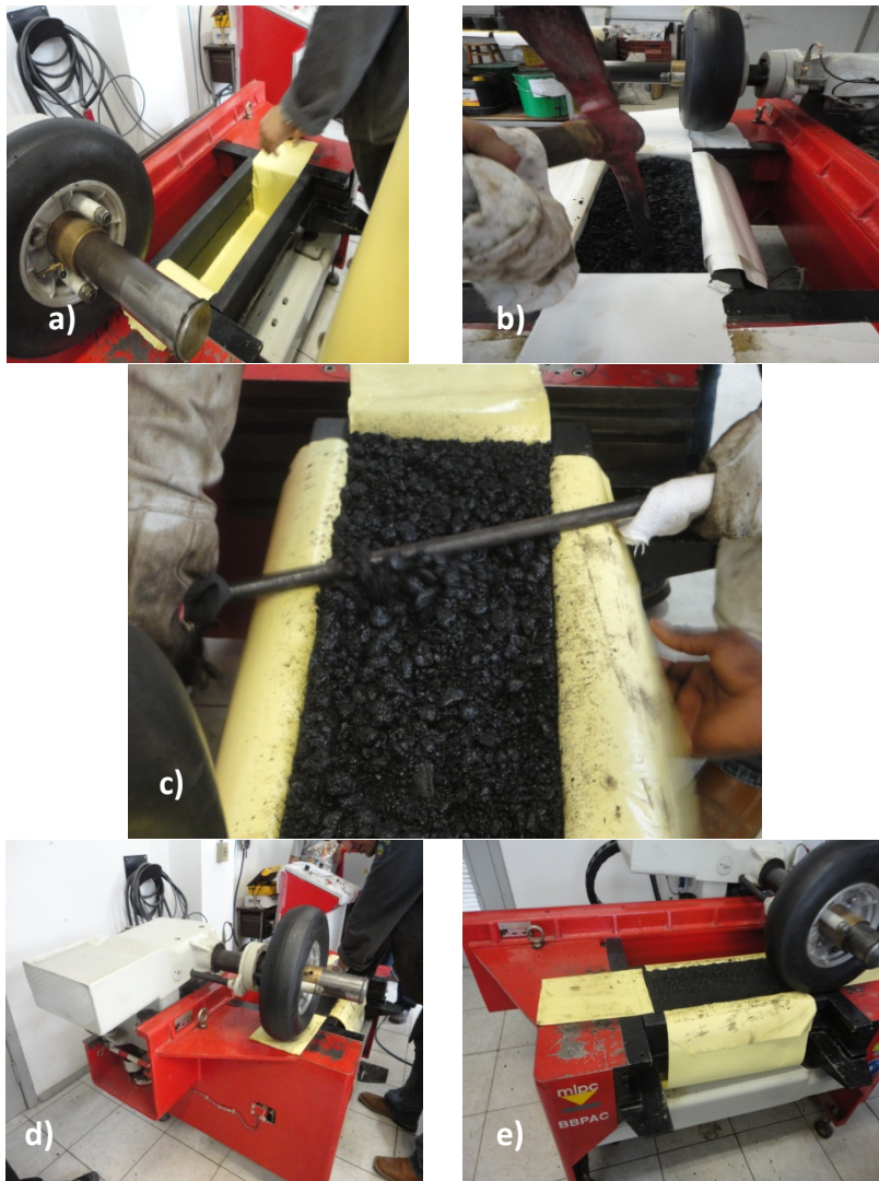
Figura 6.20 – Processo de compactação das placas de deformação permanente. Adequação do conjunto (a), Homogeneização da mistura (b), Nivelção da mistura no molde (c), Processo de compactação (d e e).
