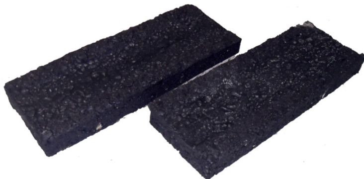
Figura 6.19 – Par de placas compactadas para o ensaio de deformação permanente
