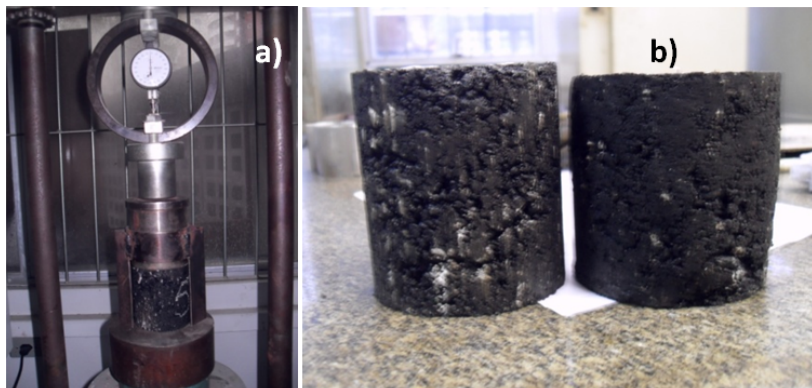
Figura 6.16 – Ensaio de compressão simples (a) e corpos de prova ensaiados (b)
