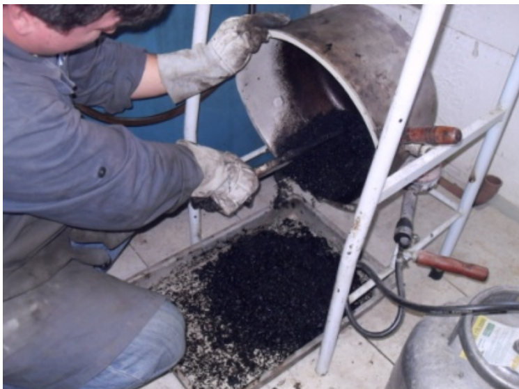
Figura 6.8 – Aspecto da mistura asfáltica após o processo de misturado
