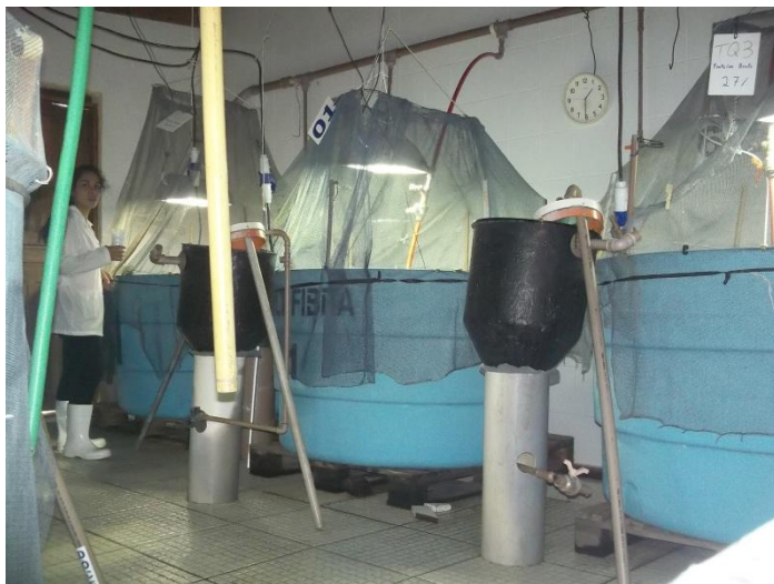
Anexo 1 – Tanques de cultivo de L. vannamei com decantadores acoplados para retirada dos sólidos suspensos da água.
