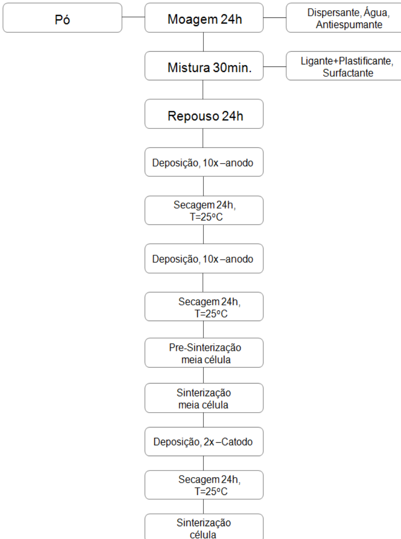
Figura 3.4 Etapas do processamento do anodo e do catodo por serigrafia
