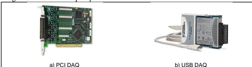
As placas de aquisição possuem como vantagem o tamanho compacto, a variedade de modelos existentes, a compatibilidade com as mais variadas aplicações.
