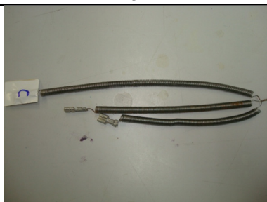
Figura 45 – Névoa salina: t12, 113 h
