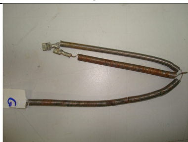
Figura 47 – Névoa salina: t11, 113 h
