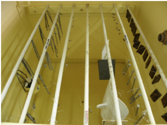
Figura 14 – Foto exibindo o posicionamento real das barras com os conjuntos de resistências (arame + terminal) selecionados
