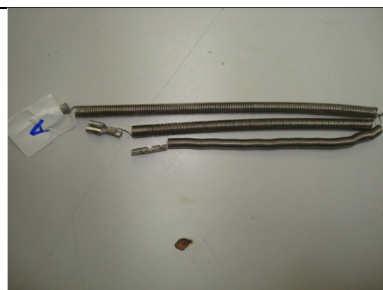
Figura 41 – Névoa salina: t28, 113 h
