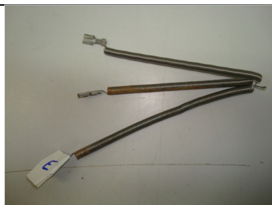
Figura 49 – Névoa salina: t1, 113 h
