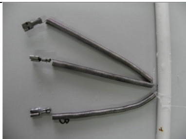
Figura 42 – Névoa salina: t26, 48 h
