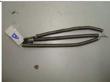
Figura 43 – Névoa salina: t26, 113 h
