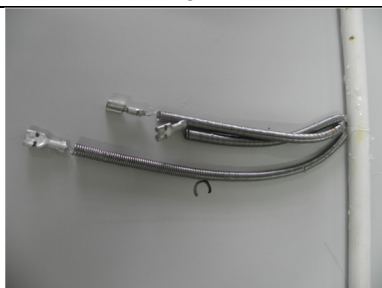
Figura 44 – Névoa salina: t12, 48 h
