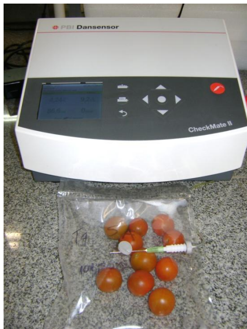
Foto 1: Avaliação da composição gasosa em analisador de gases.
