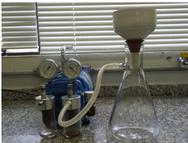
Figura 25 – Equipamentos para filtração do extrato lixiviado
