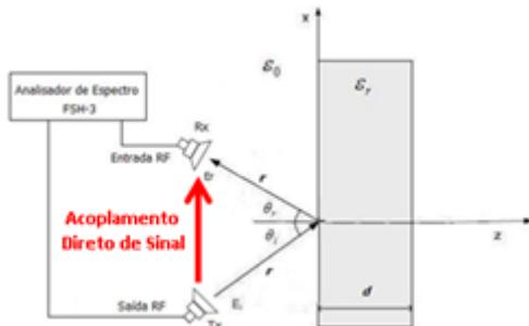
Figura 59: Problema Técnico Referente ao Método de Reflexão de Duas Portas.
