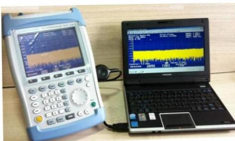
Figura 11: Analisador de Espectro FSH-3 Conectado a um Laptop.
