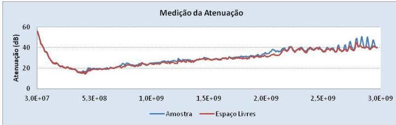
Figura 66: Resultado da Medição de Atenuação da Porta para 1m de Distância Entre as Antenas.
