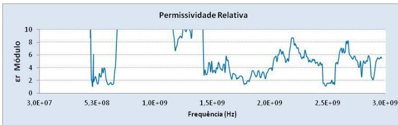
Figura 98: Resultados Obtidos da Permissividade Relativa Complexa da Divisória para 3m de Distância entre as Antenas.
