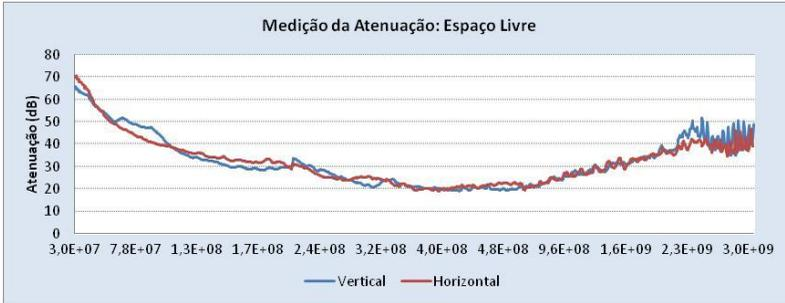
Figura 28: Resultado da Medição de Atenuação para o Ensaio no Espaço Livre.
