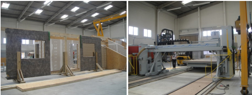
Figura 31 – Interior da fábrica EcosHaus: produção de painel de parede (esquerda) e maquinário de produção (direita).
